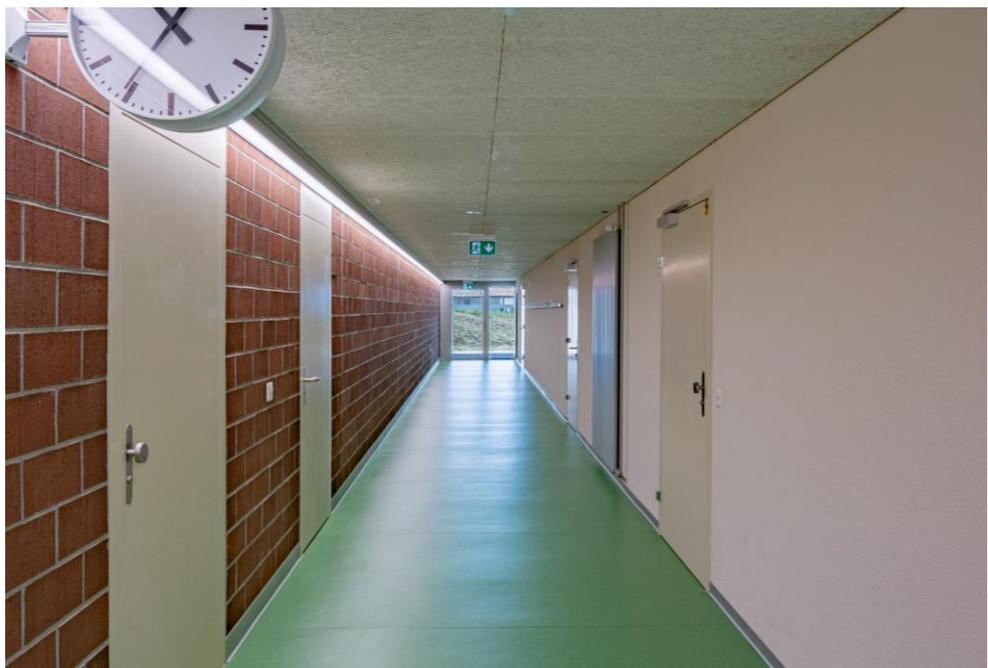
Korridor – neuer Bodenbelag auf bestehende Platten / neue Deckenverkleidung / Ersatz Türen
